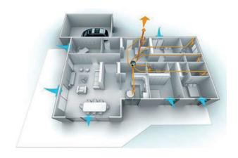
Su funcionamiento está basado en el principio de barrido del aire dentro de las viviendas desde las habitaciones secas (dormitorios y salón) hasta los cuartos húmedos (cocina y baños). Debido a que el sistema dispone de rejillas, el caudal de ventilación se adapta de manera automática a las necesidades de los ocupantes de cada estancia, en función de la tasa de humedad, aportando un mayor nivel de confort y ahorro energético a los sistemas de climatización.
